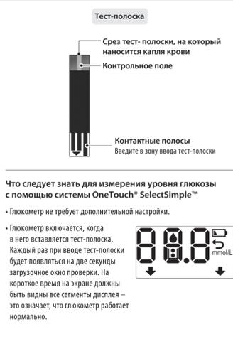
Каждый раз, когда вы вставляете тест-полоску, глюкометр, прежде чем предложить нанести кровь, отображает последний результат измерения (уровень глюкозы или результат теста с контрольным раствором). Если глюкометр используется впервые или после замены батареек, вместо этого отображаются три тире (---).
